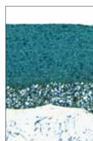
Querschnitt der Flygt-Epoxydharzbeschichtung
